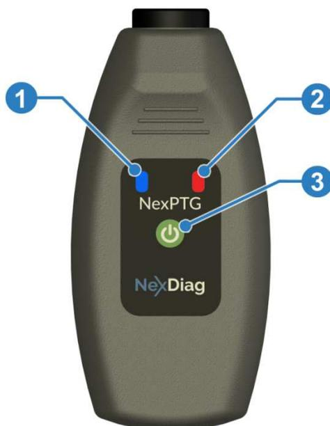
Para iniciar el medidor **NexPTG**, el botón **3** **debe mantenerse presionado durante tres segundos** hasta que el diodo de encendido se encienda en el panel **2**. Luego, inicie la aplicación **NexPTG** en el dispositivo móvil (externo). La comunicación correcta será señalada por el encendido del diodo azul **1**.
